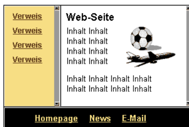
9.1: Der typische Aufbau einer Web-Seite mit drei Frames.
