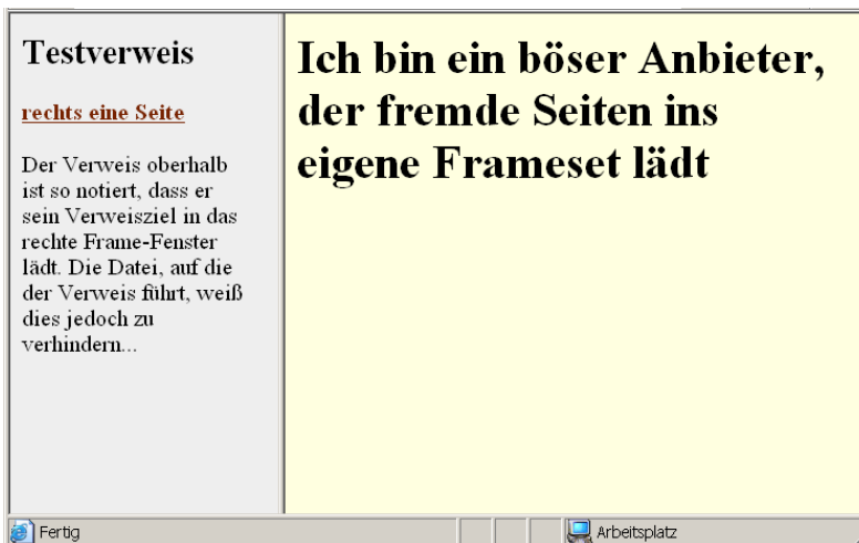
19.2: Wird die Beispieldatei in das Frame rechts geladen, so übernimmt sie die Kontrolle und füllt das ganze Browser-Fenster.
